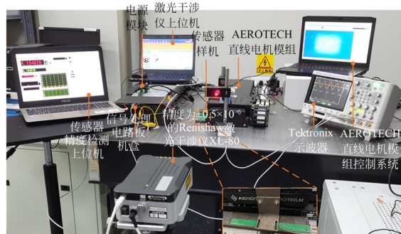
图 17 时栅位移传感器误差特性实验平台
